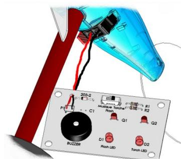
Place le ventilateur devant l'éolienne afin de simuler le vent, puis, dès que le rotor commence à pivoter, observe ce qui se passe au niveau du module « **son et lumière** » lorsque celui-ci est en position musique, torche ou encore flash.
