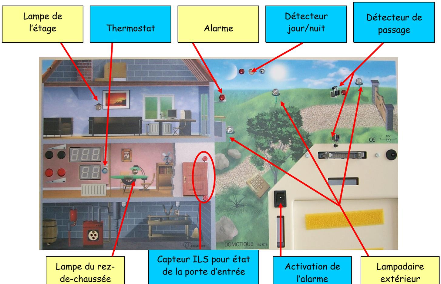
identifier les capteurs, actionneurs et effecteurs sur une maquette
