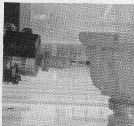
L'usinage d'un décor en pierre
