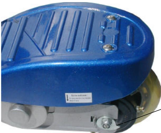
**Lors de l'utilisation de la trottinette, vérifiez que la courroie est bien tendue. Vous pouvez à l'aide de l'écrou situé de chaque côté de la roue retendre la courroie.**
